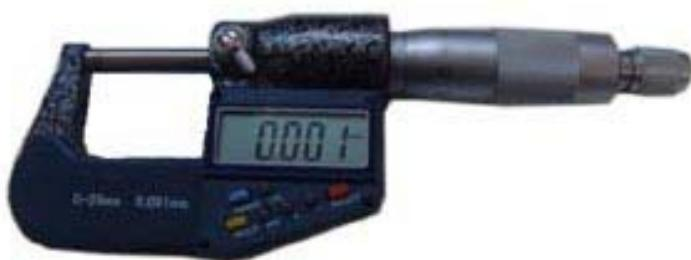
یکی دیگر از ابزارهای دقیق میکرومتر می باشد، که در انواع مختلف ساخته می شود، به این شکل که ما میکرومتر خارج سنج داریم که می تواند سطح خارجی اجسام را اندازه بگیرد و میکرومتر داخل منبع که سطح داخلی اجسام را اندازه گیری می کند.
