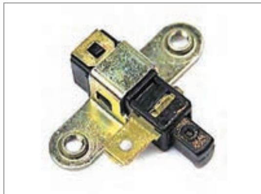
شکل ۲۴- میکرو سوئیچ ترمز دستی و محل بستن آن
