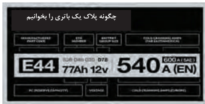
شکل ۴۴- دو نوع پلاک باتری و نحوه خواندن آن
