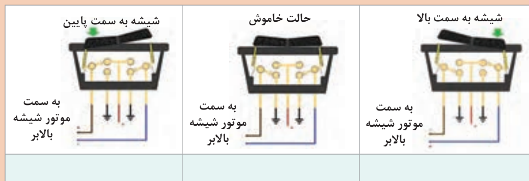
شکل ۶- عملکرد کلید شیشه بالابر الکتریکی
