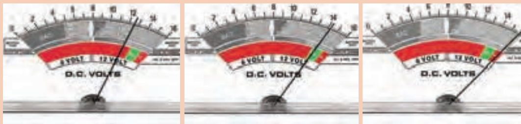
شکل ۷۳- آزمایش تحت بار سیستم شارژ
