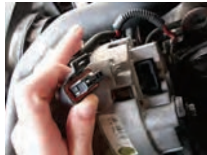
بررسی ظاهری کانکتورها از نظر شکستگی
