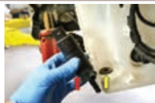
شکل ۳۱- مراحل تعویض پمپ شیشه شوی
