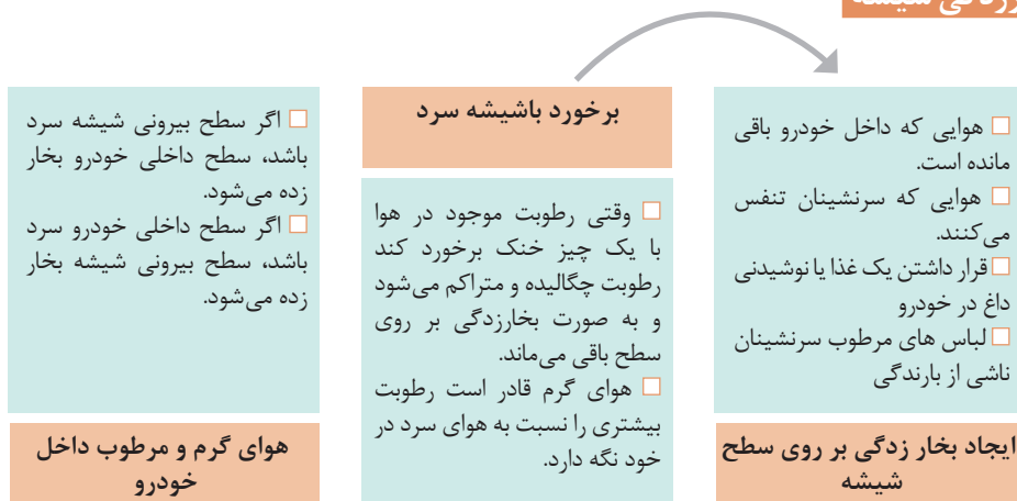
شکل ۳۳- فرایند بخار زدگی شیشه‌ها
