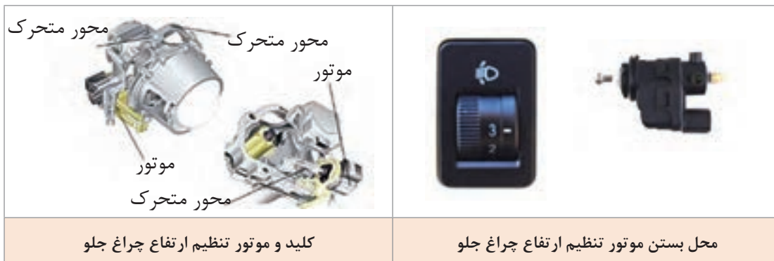
شکل ۱۰- موتور تنظیم ارتفاع چراغ جلو و محل بستن آن
