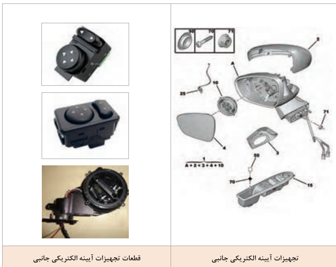
شکل ۱۱- نمونه تجهیزات مربوط به آینه جانبی الکتریکی
