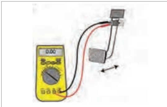
شکل ۳۴- آزمایش فشنگی پدال ترمز (یک نوع کلید)
