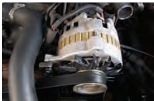
بررسی تسمه از نظر خرابی، پارگی
