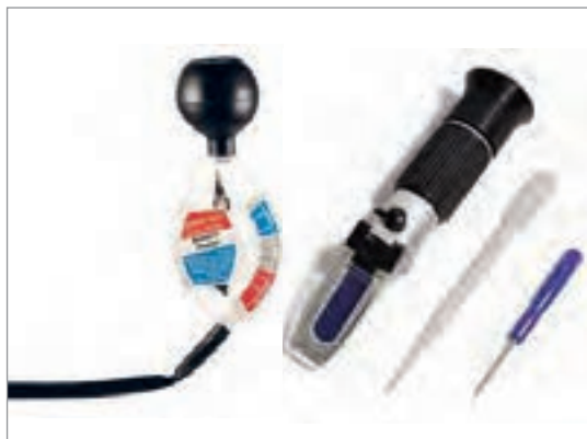
شکل ۴۷- نحوه بررسی الکترولیت در باتری
