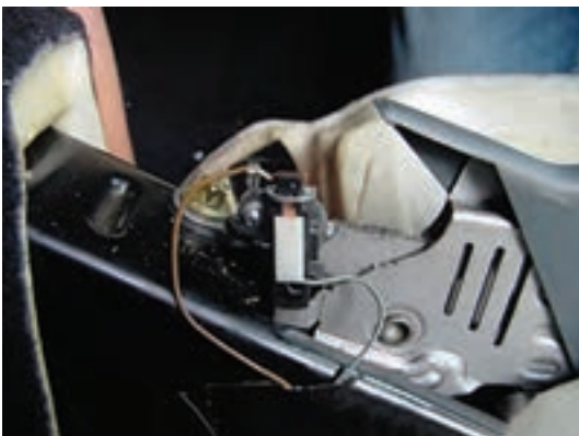
شکل ۲۴- میکرو سوئیچ ترمز دستی و محل بستن آن
