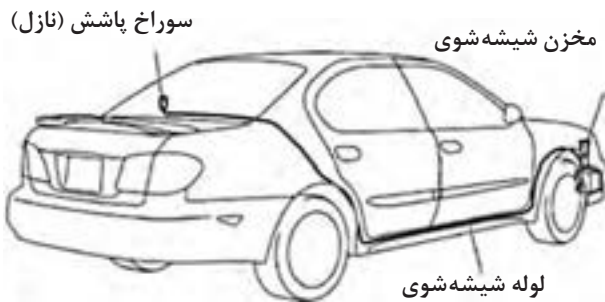
شکل ۱۶- لوله کشی آب در شیشه شوی خودرو
