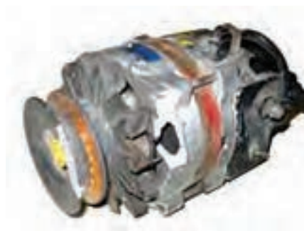
بررسی بدنه از نظر شکستگی بدنه یا صدا
