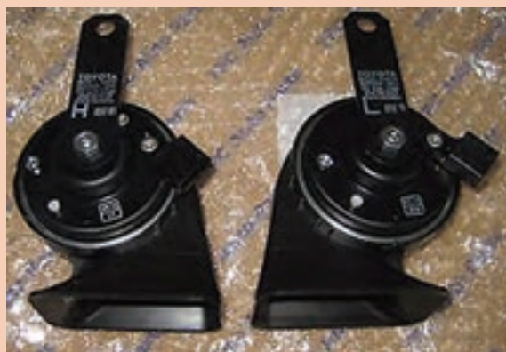
شکل ۵۰- درج L و H روی دستگاه بوق
