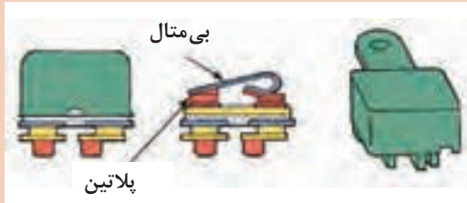
شکل ۱۴- نمونه ای از دستگاه کنترل جریان الکتریکی مدار
