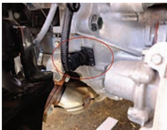
شکل ۱۸- حسگر دور موتور و محل بستن آن
