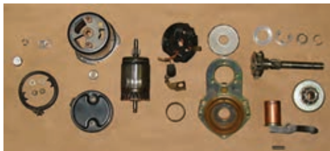
شکل ۹۷ – اجزای استارت تر با بالشتک آهنربای دائم
