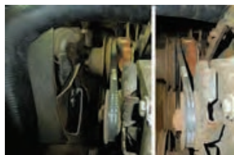
بررسی ناهمراستایی تسمه و میزان کشش
