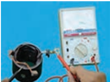
- آزمایش اتصال بدنه بالشتک ها
