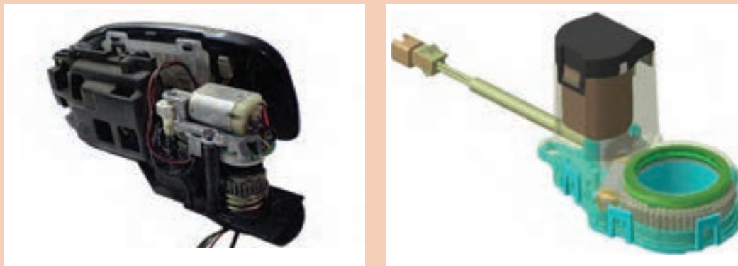
شکل ۱۵- دو نمونه از موتور مخصوص آئینه تاشونده الکتریکی
