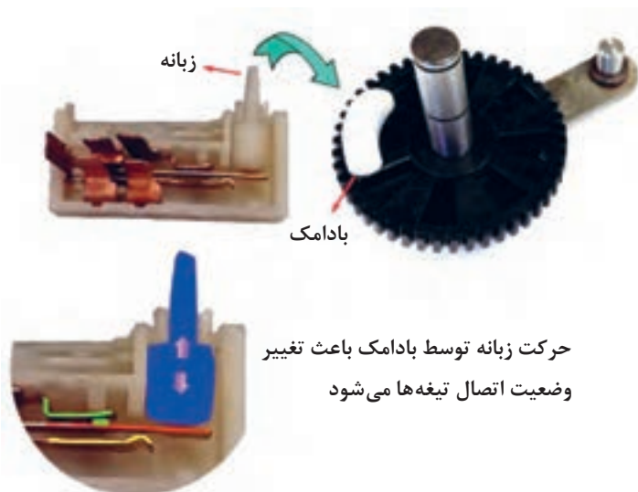
شکل ۸- کلید پارک از نوع پلاتین و بادامک
