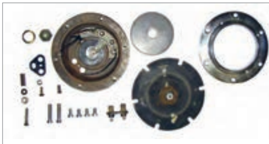
شکل ۴۷- اجزای داخلی بوق الکترومغناطیسی
