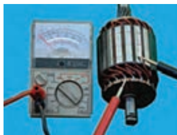
- آزمایش اتصال بدنه آرمیچر
