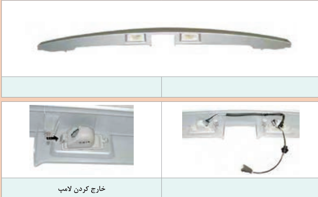
شکل ۳۵- روش باز کردن و بستن چراغ پلاک
