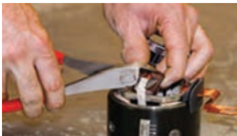
شکل ۹۹ – برخی نکات لحیم کاری زغال‌های استارتر
