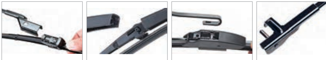
شکل ۲۴- روش‌های اتصال تیغه برف پاک‌کن
