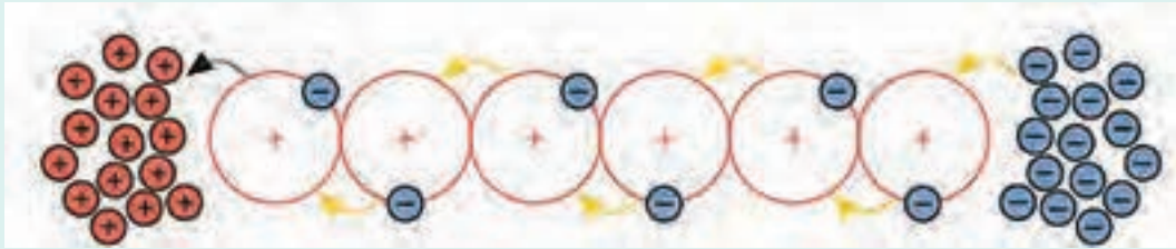
شکل ۱- حرکت الکترون‌ها در یک رسانا
