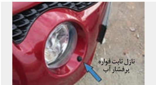
شکل ۱۹- روش های تمیز کردن چراغ
