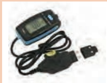
شکل ۳۲- دو نوع دستگاه تست فیوز خودرو
