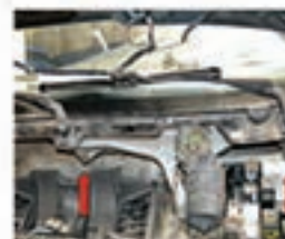
۶- سیم‌های موتور برف پاک‌کن را از اتصال دسته سیم مولد جدا کنید.
