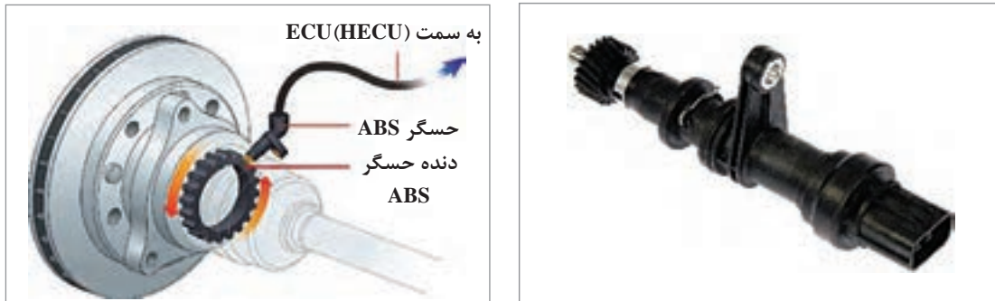
شکل ۱۶- حسگر سرعت خودرو از نوع القایی
