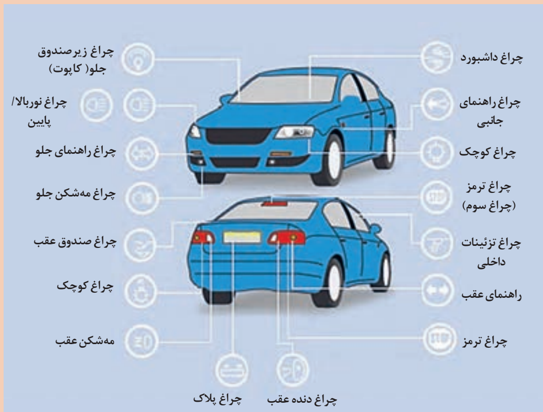
شکل ۳- محل قرارگیری چراغ‌های روشنایی خودرو
